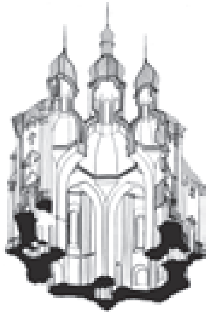
М. Цапенко. Аксонометричний переріз конструкції Катерининської церкви в Чернігові
